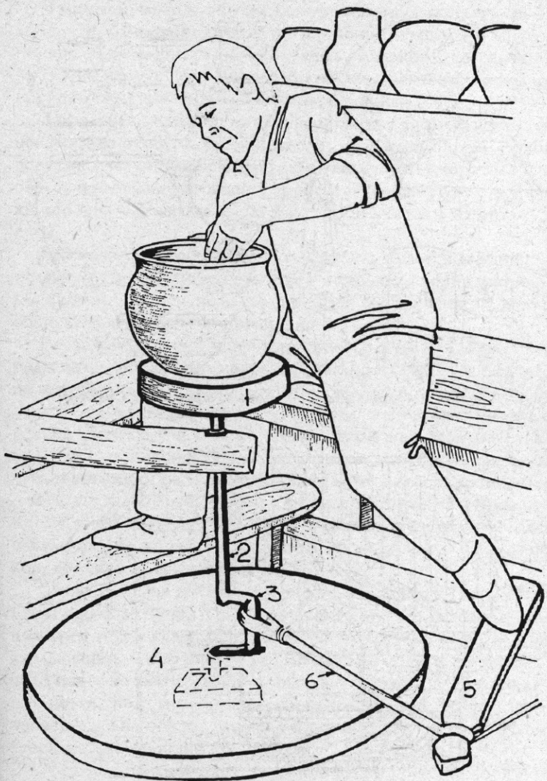
Рис.1. 1 - вершник, 2 - веретено, 3 - колено, 4 - нижник, 5 - отмоток, 6 - ремень.
